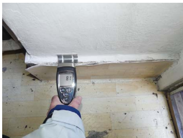
14. kép: Földszinti lakás, közepesen nedves szerkezet
